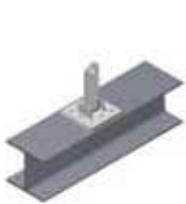
Saldatura (previa rimozione della zincatura)
