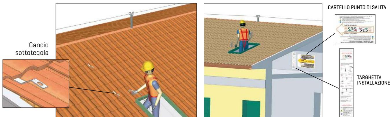
In prossimità del punto di accesso alla copertura, comunque in un punto di immediato riscontro, prevedere la targhetta di installazione. Tale targhetta, da compilare in modo leggibile e permanente [inchiostro indelebile, punzonatura, ecc...], identifica il sistema di ancoraggio installato indicando:
